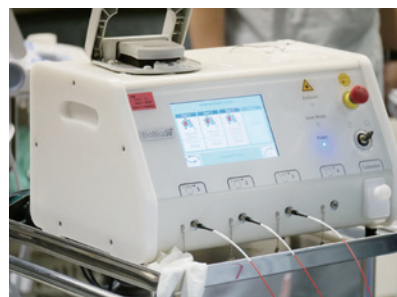
光免疫療法で用いる近赤外線光の照射装置。照射タイプ・時間はタイマーで管理されており、術者の負担が軽減されています。
